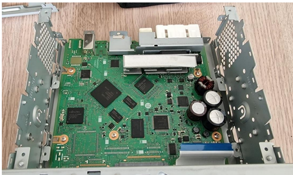
11. ábra Jármű fejegység nyomtatott áramkörti lapján találhatóak a releváns adatokat tároló integrált áramkörök
