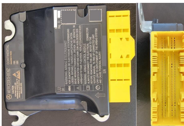
5. ábra Légszakvezérlő, mint a baleseti adatok rögzítésére szolgáló vezérlő és speciális csatlakozója
