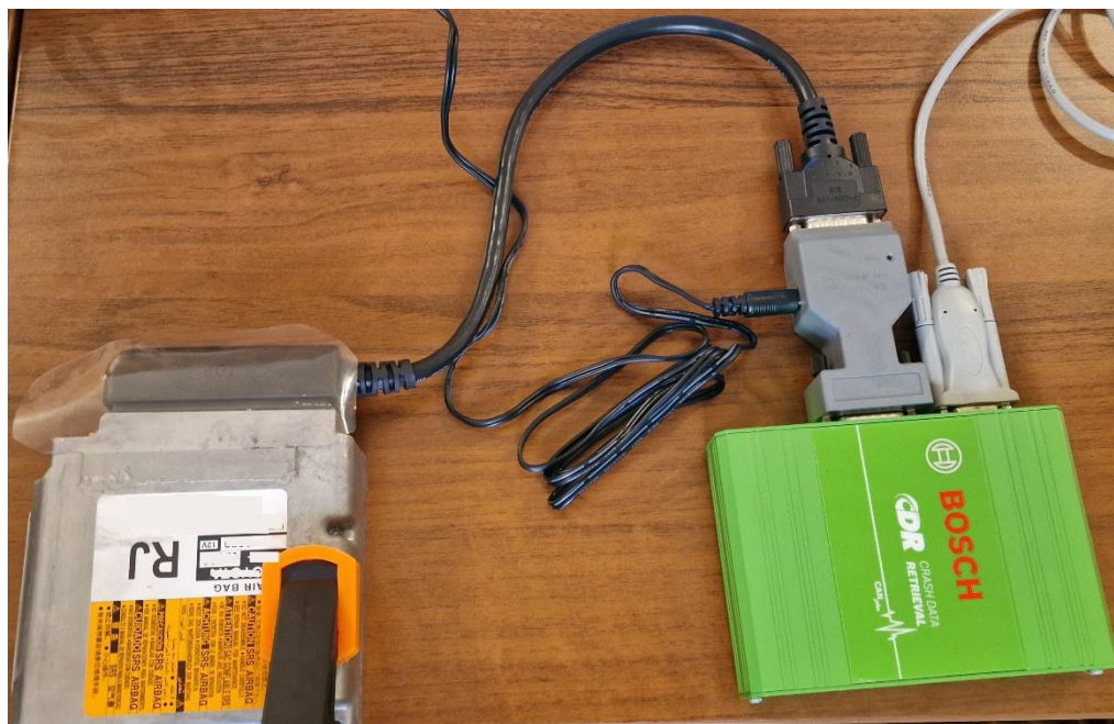
6. ábra Légzsákvezérlő csatlakoztatási módja CDR olvasóhoz
