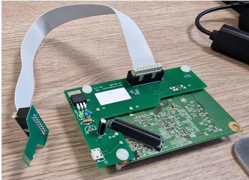
10. ábra Bench-top adatkinyerés esetén a járműből kisserelt fejegység nyomtatott áramköri lapjához csatlakoztatott modul segítségével csatlakoztatható az adattároló a szakértői számítógéphez.
