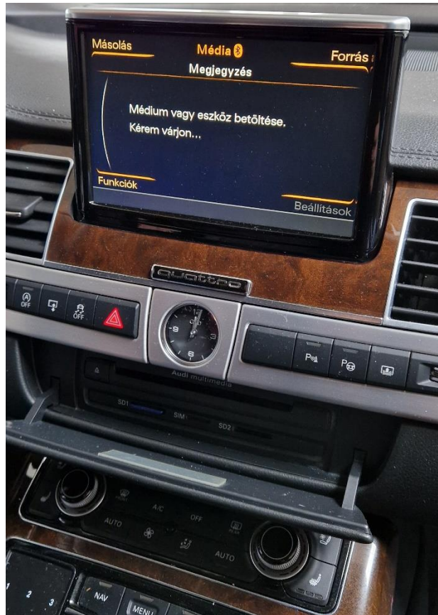
7. ábra Adatkinyerés jármű fejegységéből, memóriakártyával
