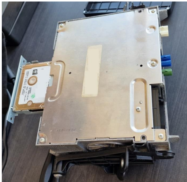
9. ábra Jármű fejegységben található HDD
